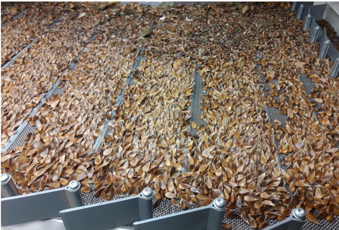
Obrázek 3 Třídění bukvic na pneumatickém třídícím stole (v přední části je kvalitní čistá bukvice, v zadní části stolu jsou nečistoty a prázdné bukvice)
