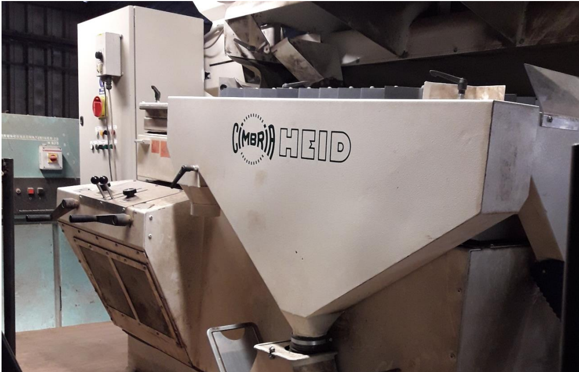
Obrázek 2 Pneumatický třídící stůl ve firmě Labris s. r. o.
