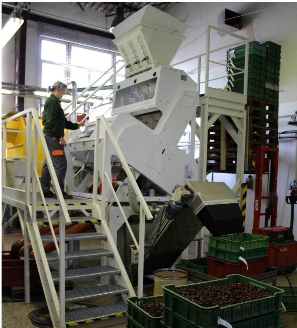
Obrázek 4 Optický třídíč v Semenářském závodě v Týništi nad Orlicí
