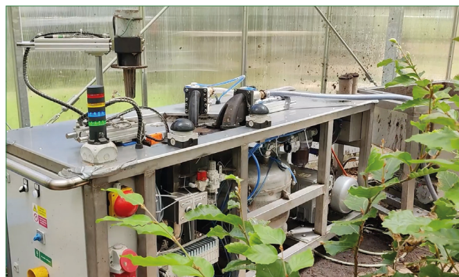
Obr. 1 Zařízení PostCont sloužící k obalování prostokořenného sadebního materiálu do prorůstavých obalů z recyklovaného papíru.
